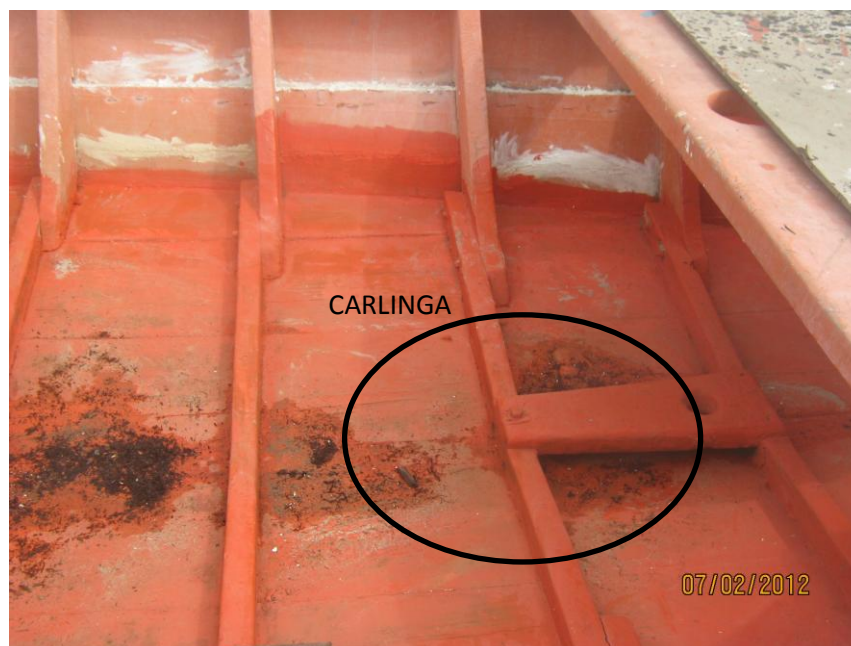
Figura 80: Fotografia da parte interna de um Bote demonstrando, os encaixes para a colocação do mastro. Fonte: Autora.
