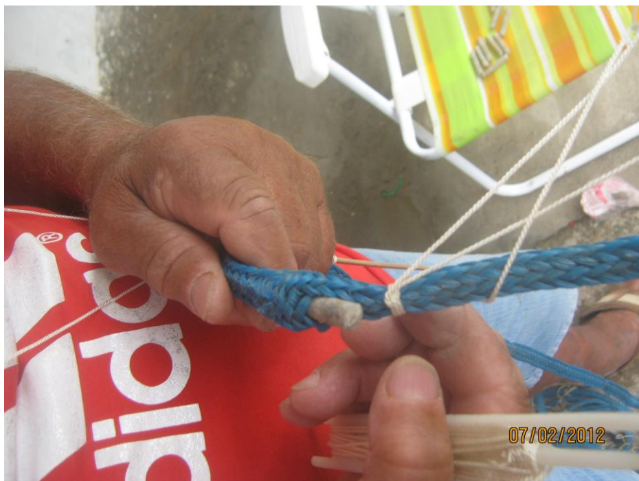
Figura 51: Fotografia mostrando como o chumbo é colocado na corda. Fonte: Autora.
